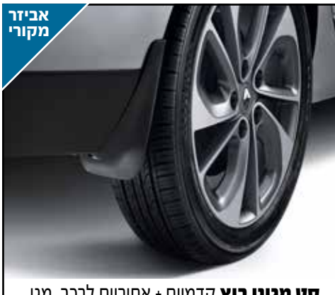
סט מגיני בוץ קדמיים + אחוריים לרכב, מגן על הרכב מפני נזקי בוץ וחצץ. קדמי LP00008502, אחורי LP00008503
